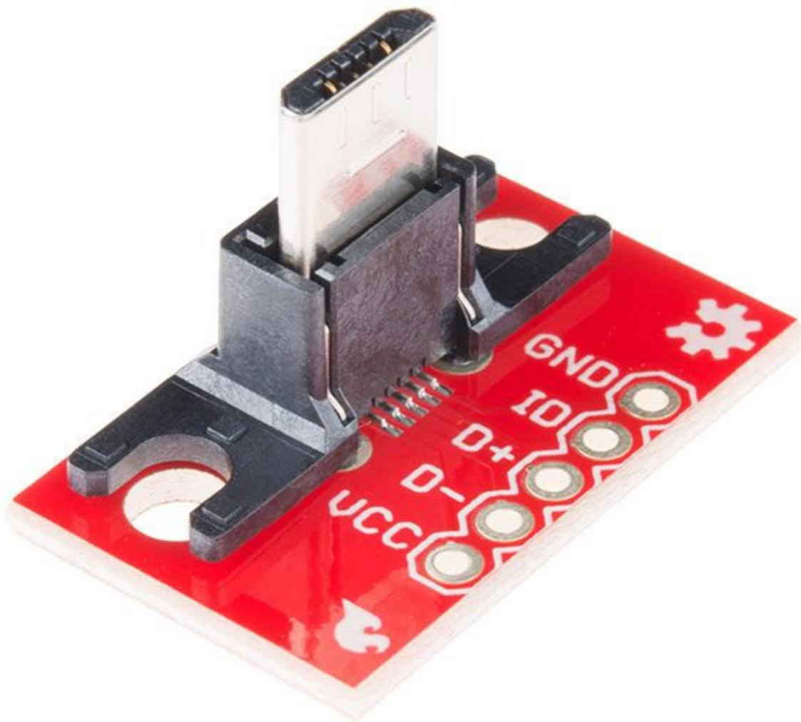
Breakout board con connettore micro USB montato in verticale e pin disponibili tramite piazzole.
