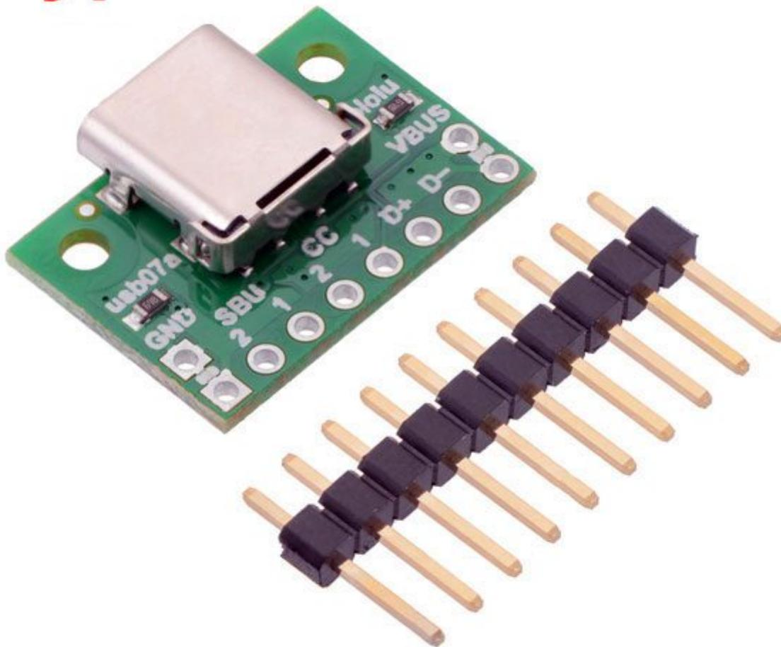
Compatta breakout board con connettore type-C femmina e pin (VBUS, GND, D+, D-, CC, SBU) disponibili tramite piazzole. Sono presenti anche due fori di fissaggio con diametro 2 mm. Dimensioni (mm): 20,4x15x4,4. Ideale per prototipazione. **N.B.** supporta solo USB 2.0.
