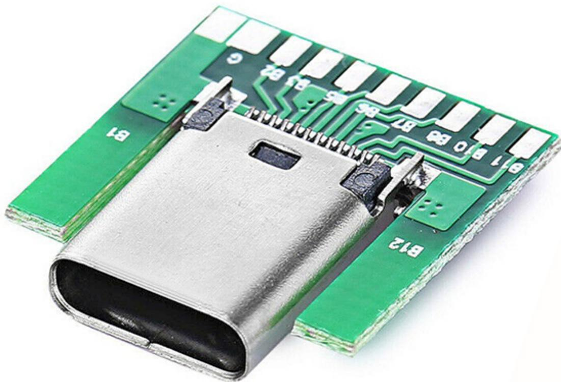
Connettore femmina TYPE-C di tipo SMT (Surface Mount Technology) ideale per la sostituzione di porte di carica danneggiate o per aggiornare i componenti e/o i progetti in cui è richiesta una connessione USB 3.1 di tipo "C". Il vantaggio di un connettore TYPE-C è che non importa l'orientamento con il quale lo si inserisce, poiché essendo di tipo "C" la direzione di inserimento del cavo è indifferente rispetto ad altri connettori USB dove è richiesto un verso di collegamento preciso.
