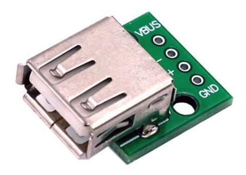
Breakout board con connettore USB 2.0 femmina (tipo A) e 4 pin (VBUS, D-, D+, GND) disponibili tramite piazzole. Dimensioni (mm): 23x17x11. Ideale per prototipazione.
