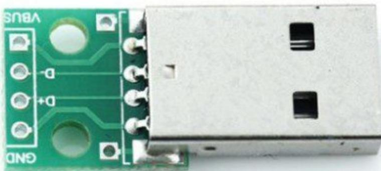
Breakout board con connettore USB 2.0 maschio (tipo A) a 4 pin (VBUS, D-, D+, GND) disponibili tramite piazzole. Dimensioni (mm): 31x15x5,5. Ideale per prototipazione.
