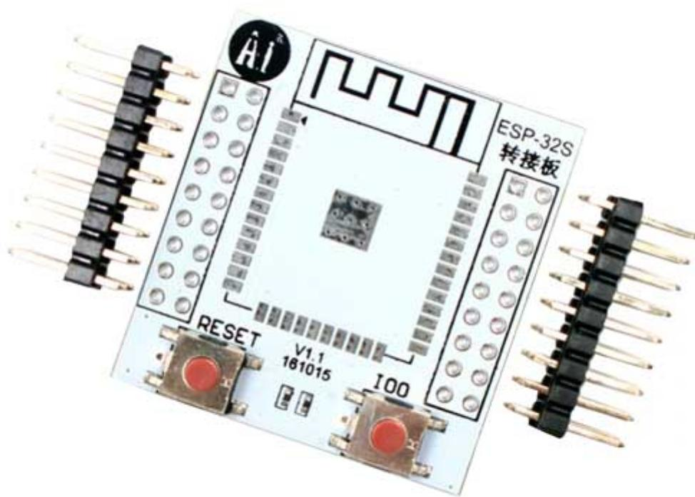
Piccola breakout realizzata appositamente per essere utilizzata con il modulo ESP32S. Rende disponibili tutti i pin del modulo su due connettori (da saldare) a 2x18 pin, pulsante di reset e IO. Dimensioni (mm): 36x35x5. **Attenzione!** il modulo ESP32 non è compreso (vedere prodotti correlati).
