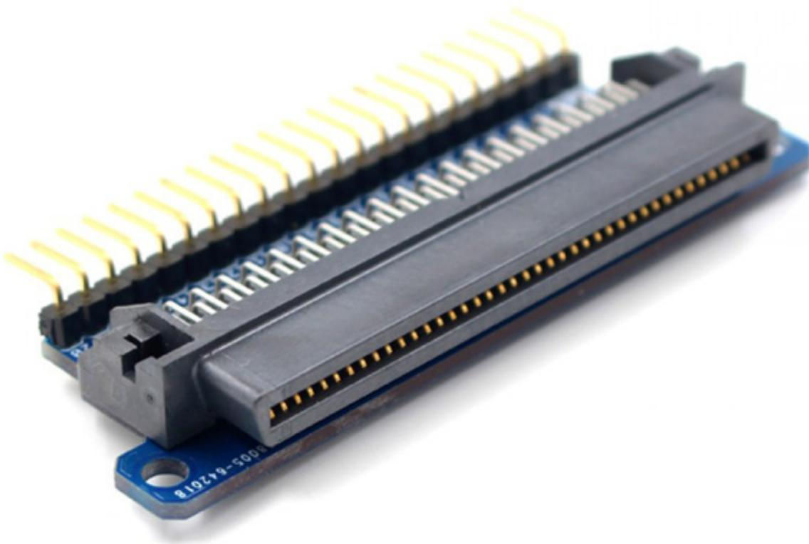
Questa breakout board, con connettore per Micro:bit, rende disponibili su un connettore strip passo 2,54 mm, tutti i 21 pin GPIO e alimentazione di Micro:bit. **N.B.** Micro:bit non è compreso.
