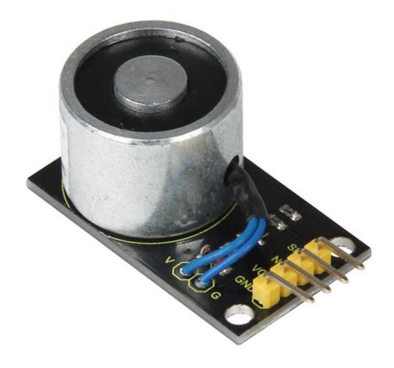
Breakout con elettromagnete di ritenuta. Si attiva portando a livello alto il pin SIG, ed è in grado di generare una forza di tenuta di circa 25 Newton (circa 2,5 kg). Per disattivare l'elettromagnete basta portare a livello basso il pin SIG. Alimentazione: da 3,3 a 5 VDC. Può essere utilizzata anche con Arduino, Fishino, Raspberry Pi (con convertitore AD) o altro microcontrollore. Aree di applicazione robotica, automazione, meccanismi di blocco/sblocco, ecc.
