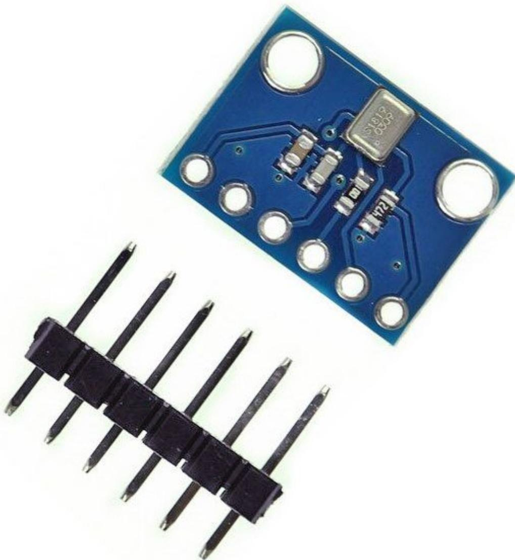
Breakout board basata sul piccolissimo microfono mono I2S MEMS. Proprio come i "classici" microfoni a elettretici, i microfoni MEMS possono rilevare il suono e convertirlo in una tensione, ma sono molto più piccoli e sottili.
