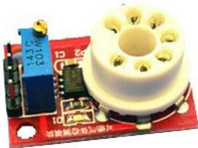
Piccola breakout realizzata appositamente per essere utilizzata con i sensori della serie MQ. Dispone di trimmer per impostare il valore della resistenza di carico dei sensori MQ, uscita analogica (AOUT) e uscita digitale (TTL). L'uscita digitale può essere collegata direttamente ad un microcontrollore. Alimentazione: 5 Vdc / 150 mA, DOUT uscita (TTL): 0 e 1 (0,1 e 5 V), uscita AOUT: segnale a livello analogico. Dimensioni (mm): 30x20x13.
