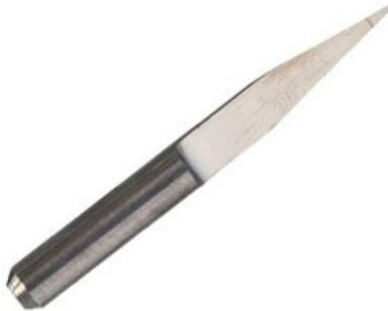
Bulino con punta in metallo duro. Adatto ad incisioni su ABS, PVC, Plastica, Acrilico, Legno, PCB. Lunghezza totale: 33 mm, offset 0,1mm, angolo di taglio 20°, lunghezza tagliente: 7 mm, diametro gambo: 3,175 mm.
