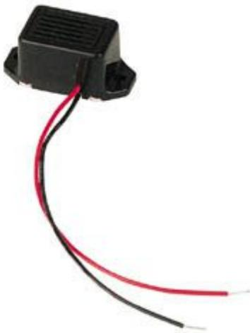
Buzzer a tono singolo, con oscillatore integrato e corpo in ABS nero completo di alette per il fissaggio. Frequenza di oscillazione 300-500Hz, pressione acustica 85dB, cavetti di collegamento (rosso/nero) da 11 cm, peso 8 grammi.
