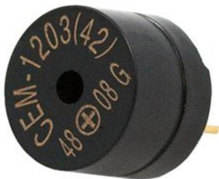
Buzzer da circuito stampato con elettronica, frequenza sonora di 2 kHz, potenza 95 dBA, diametro 12 mm, alimentazione compresa tra 3,5 e 5 Vdc e consumo di 35 mA.
