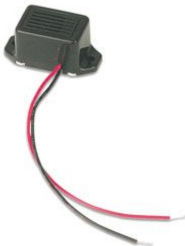
Buzzer singolo tono, alimentazione: da 8 a 15 Vdc, consumo: 25 mA, pressione sonora: 25 dB, frequenza di oscillazione: 300-500 Hz, peso: 10 g.
