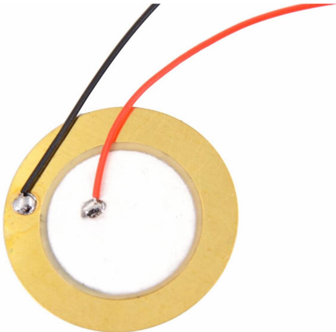
Buzzer piezoelettrico con fili. Diametro: 27 mm, spessore: 0,3 mm, frequenza di risonanza: 2,5 kHz (+/- 0.5 KHz), impedenza di risonanza: 200 ohm, temperatura di lavoro: da -20°C a +70°C.
