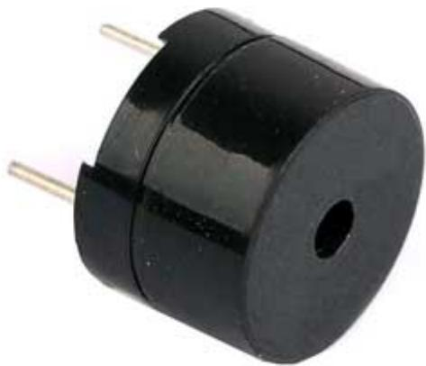
Buzzer da circuito stampato senza elettronica, potenza 95 dBA, dimensioni (mm): diametro 12 x altezza 8,5, alimentazione compresa tra 3,5 e 5 Vdc e consumo di 35 mA.
