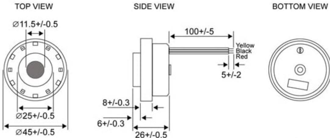
Buzzer piezoelettrico a tono singolo o ad impulso. Frequenza di oscillazione: 2,9 kHz, livello sonoro: 100 dB. Alimentazione: da 3 a 18 Vdc, consumo: 30 mA, colore bianco, peso 22 grammi.
