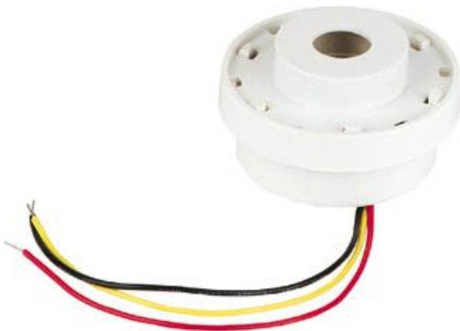
Buzzer piezoelettrico a tono singolo o impulso. Frequenza di oscillazione: 2,9 kHz, livello sonoro: 105dB. Alimentazione: da 1 a 13 Vdc, consumo: 30 mA, colore bianco, peso 22 grammi.
