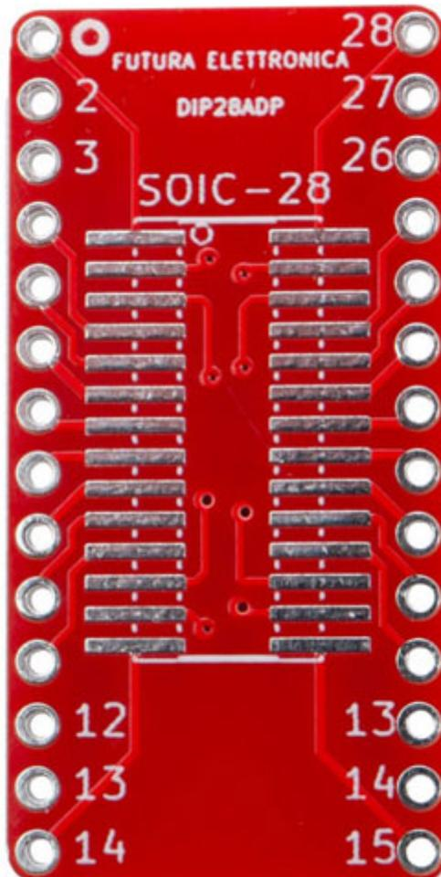
Piccolo circuito stampato che permette di adattare componenti con case SSOP28, SOIC28 a DIP28. Dimensioni (mm): 35,5x17,7x1,6.
