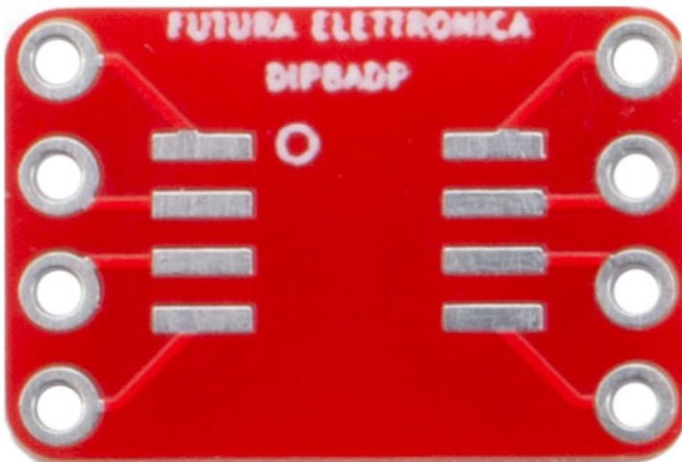
Piccolo circuito stampato che permette di adattare componenti con case SSOP8, SOIC8 a breadboard e millefori passo 2,54 mm. Dimensioni (mm): 15,35x10x1,6.
