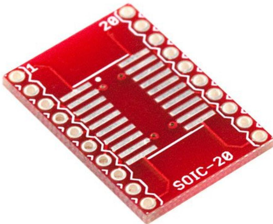
Piccolo circuito stampato che permette di adattare componenti con case SOIC20 a DIP20.
