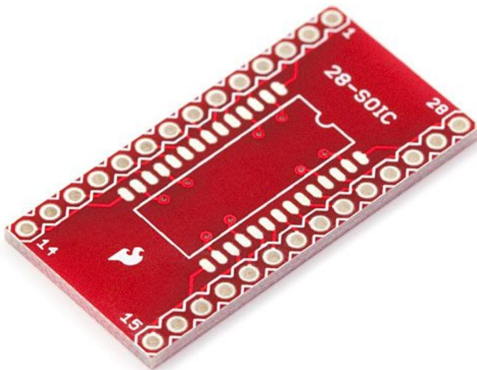
Piccolo circuito stampato che permette di adattare componenti con case SOIC28 a DIP28.
