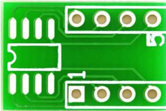
Piccolo circuito stampato che permette di adattare componenti con case SOIC8 a DIP8.
