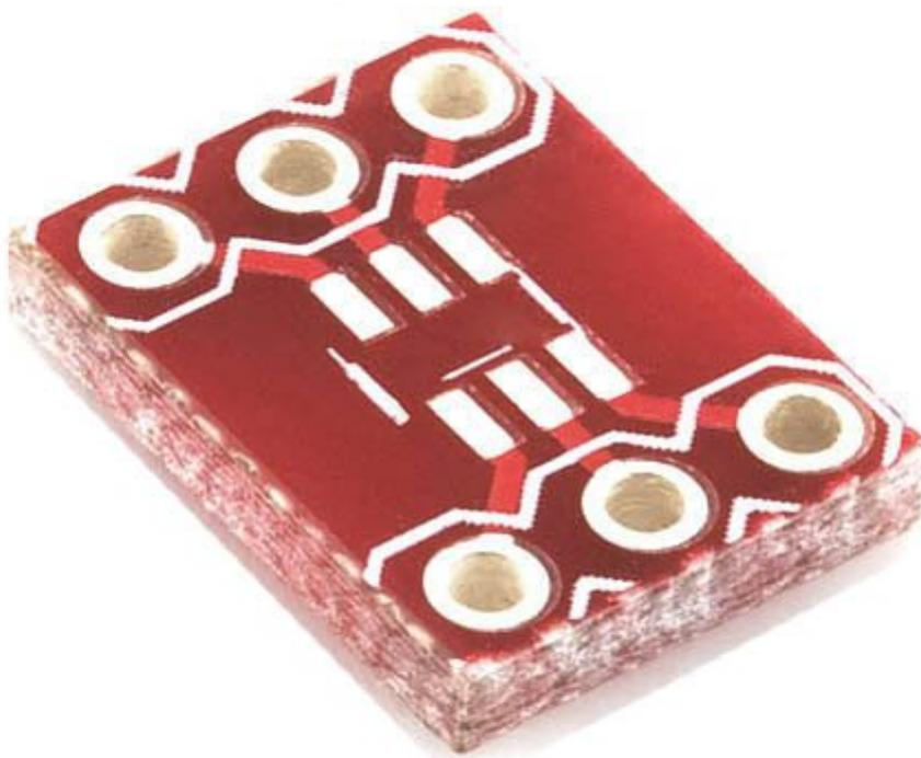
Piccolo circuito stampato che permette di adattare componenti con case SOT-23 a DIP6.
