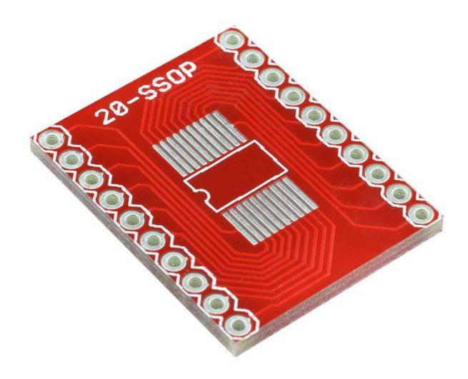
Piccolo circuito stampato che permette di adattare componenti con case SSOP20 a DIP20. Dimensioni: 25,65 x 18 mm. Si adatta a tutti i dispositivi SSOP standard (600 mil).
