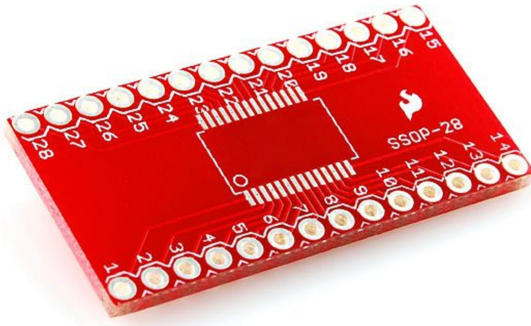
Piccolo circuito stampato che permette di adattare componenti con case SSOP28 a DIP28. Dimensioni: 35,5 x 18 mm. Si adatta a tutti i dispositivi SSOP standard (600 mil).
