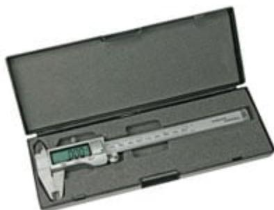
Estremamente preciso ed affidabile! È caratterizzato da un'ampio display LCD a 5 cifre che permette di visualizzare il valore misurato in mm o in pollici e dispone di rotella zigrinata per regolazione fine. Consente di eseguire misure accurate di profondità, interno, esterno e passo con precisione di 0,01 mm. Apertura massima 150 mm; corpo e ganasce in acciaio inossidabile. Fornito in pratica custodia in PVC. Batteria inclusa.
