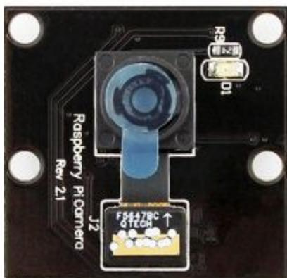
Fotocamera a colori per Raspberry Pi con sensore CCD da 1/4" Omnivision OV5647 da 5 Megapixel, filtro per gli infrarossi, ottica fissa, apertura (F): 2,8, lunghezza focale: 3,37 mm, angolo di ripresa: 72,4°. È in grado di scattare foto con una risoluzione di 2592x1944 pixel, riprese video HD in formato 1080p a 30 fps, dando la possibilità agli utilizzatori delle schede Raspberry Pi di realizzare applicazioni video. Il modulo si innesta sul connettore CSI.
