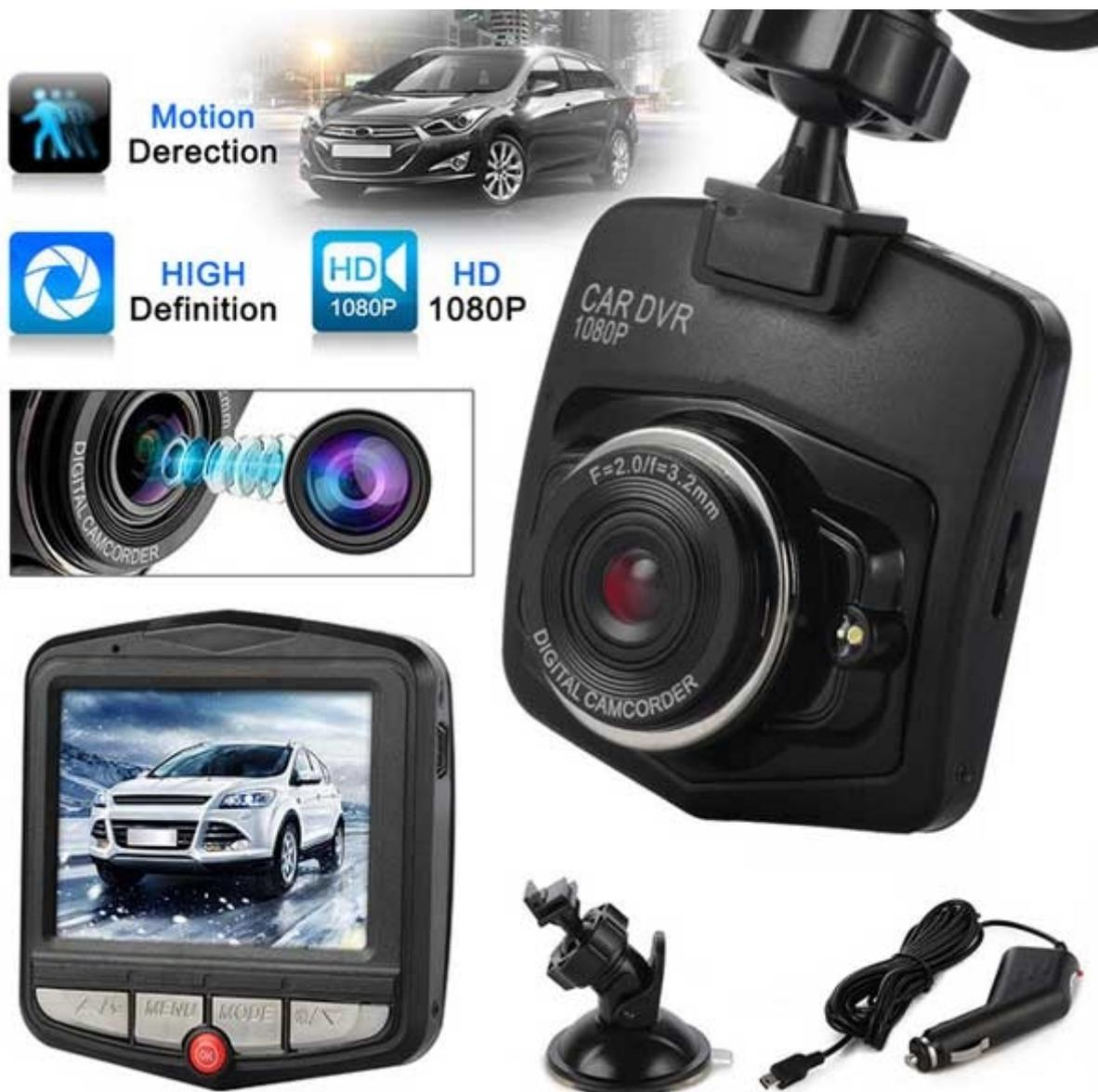
Telecamera a colori dotata di monitor LCD a colori da 2,4", microfono integrato, altoparlante e supporto con ventosa. Progettata per essere montata sul parabrezza di un'auto, permette di catturare immagini o video (HD). Il monitor permette di visualizzare ciò che la telecamera sta riprendendo e registrando. Nella micro SD card (max. 32 GB – non inclusa) vengono salvate le sequenze video e le immagini. La registrazione ha inizio quando la telecamera riceve
