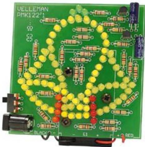
Campana in movimento con 83 LED. Non è necessario rimuovere la batteria quando si usa un'alimentazione esterna. Alimentazione a 12 per auto o camion. Interruttore on/off incluso. Alimentazione: adattatore 9 - 12 VDC o batteria alcalina 9V (non inclusa)
