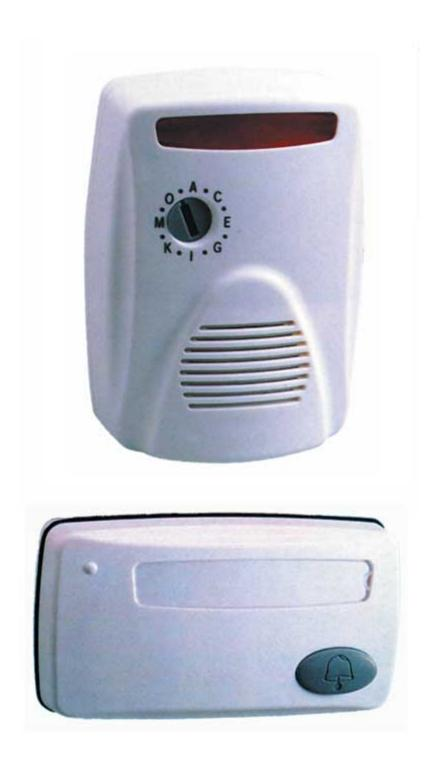
Composto da un trasmettitore alimentato da una batteria (compresa nella confezione) in contenitore da esterno e da un ricevitore collegabile direttamente alla presa 220V. Non necessita di alcun collegamento elettrico in quanto lavora via radio fino ad una distanza tra RX e TX di circa 30 metri. Consente di selezionare il canale su cui trasmettere tra i 16 disponibili in modo da rendere possibile I
