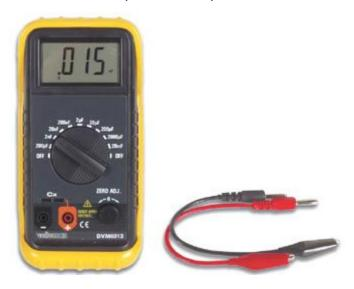
Capacimetro digitale portatile dotato di display LCD a 3 cifre ½ in grado di effettuare misure di capacità da 0,1 a 20 mF. Completo di regolazione dello zero e di custodia in gomma con aletta di sostegno. Alimentazione con pila a 9 V.
