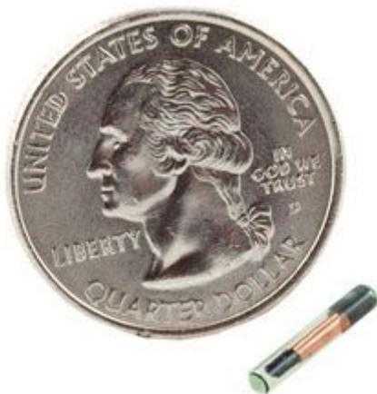
Inserito in una piccolissima capsula in vetro, questo RFID passivo è molto simile a quelli applicati [nel tessuto sottocutaneo degli animali ai fini della identificazione](#). Ogni tag è dotato di un codice univoco di 32 bit e non è riprogrammabile. Perfetto per essere utilizzato con il modulo ID12.
