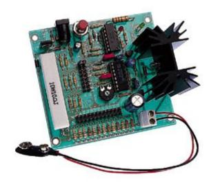
Sul mercato, sono disponibili molti caricabatterie, ma pochi, tra essi, sono universali. Ricorrendo al nostro kit, batterie Ni-Cd e Ni-MH, di differenti tensioni e capacità, potranno essere ricaricate in modo rapido (52 minuti), o normale (14 ore). Per assicurare cicli di vita più lunghi alle batterie, occorre assicurarsi che esse siano completamente scariche prima di iniziarne la ricarica. A questa operazione, provvede un apposito scaricatore automatico, integrato nel circuito.
