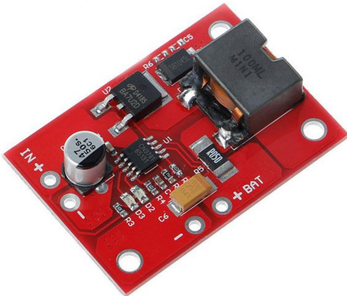
Basato sul chip CN3791 e dotato di due LED di stato, questo compatto caricabatteria con tecnologia MPPT (Maximum Power Point Tracking), permette di ricaricare una batteria ai polimeri di litio da 3,7 volt, attraverso un pannello solare con tensione di uscita di 6 volt. La corrente massima in uscita è di 3 A. **N.B.** la batteria e il pannello solare non sono compresi (vedere prodotti correlati).
