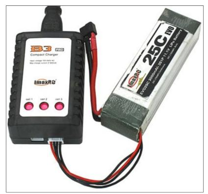
3. Quando tutti e 3 i LED diventano verdi, la batteria sarà completamente carica.
