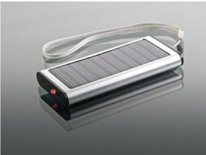
Caricabatteria dotato di pannello solare policristallino e batteria integrata agli ioni di litio. È in grado di fornire sul connettore d'uscita una tensione di 5 V e una corrente massima di 800 mA. Indispensabile, quando siamo all'aperto e la rete elettrica non è disponibile, per ricaricare dispositivi quali lettori MP3/Mp4, PDA e cellulari. Il caricabatteria può essere alimentato, oltre che dall'energia solare, anche da una tensione di 5 Vdc (tramite porta USB o alimentatore da rete).
