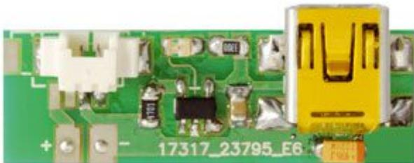
Compatto caricabatterie per batterie al litio. Per facilitare le operazioni di ricarica utilizza un connettore mini-USB del quale vengono utilizzati solo i piedini di alimentazione a 5 volt, ossia 1 (+) e 4 (-). L'impiego del connettore mini-USB, oltre a permettere di ottenere una connessione fisicamente più robusta e pensata per moltissimi cicli di inserzione e distacco, permette di prelevare i 5 volt da qualsiasi Personal Computer (o Mac) anche portatile.
