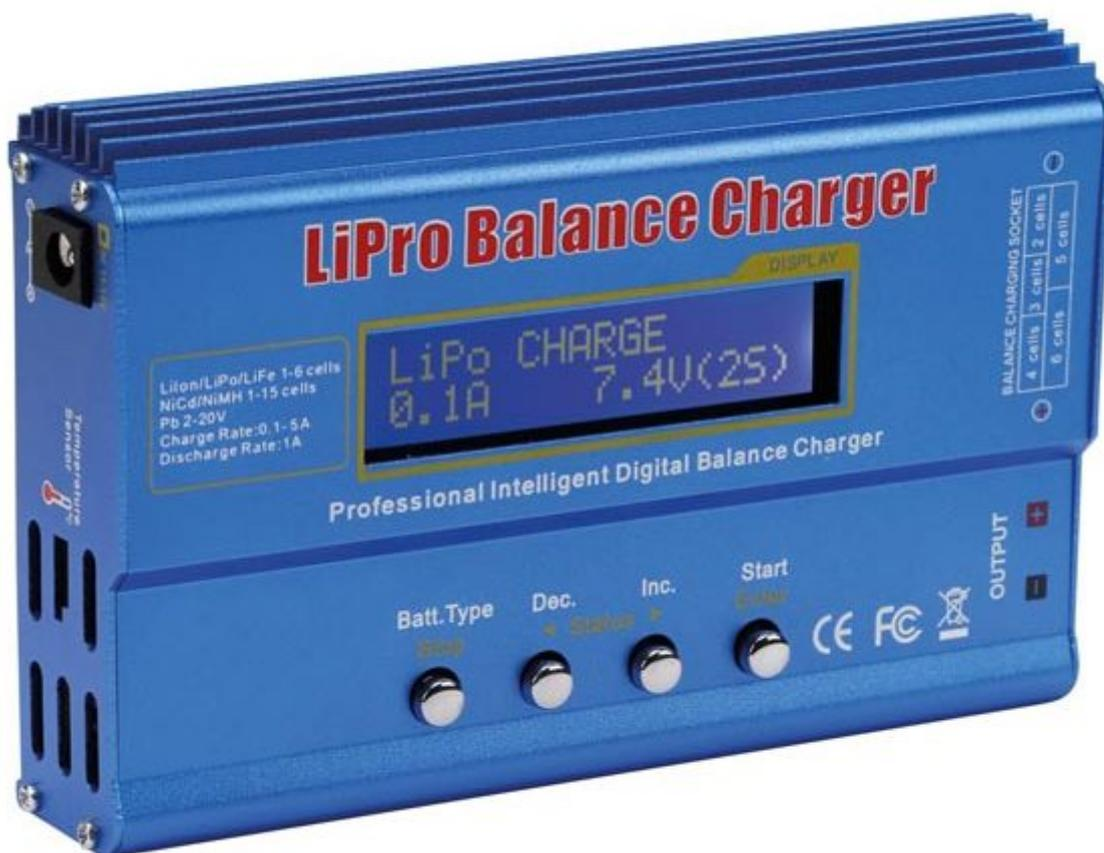
Caricabatterie programmabile controllato da microcontrollore in grado di caricare e scaricare batterie ricaricabili al Li-poly, Li-Ion, Li-Fe, Ni-Mh, Ni-Cd e al Piombo. E' dotato di un regolatore di tensione separato per ciascuna cella. Completo di un vasto corredo di cavi, spine. Carica fino a 6 celle li-poly e fino a 15 celle Ni-MH.
