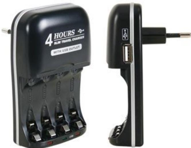
Caricabatteria per batterie Ni-MH con uscita USB 5 Vdc. Permette di caricare 2 o 4 batterie AA o AAA Ni-MH contemporaneamente, dispone di LED indicatore di ricarica della batteria, protezione da inversione di polarità, timer di sicurezza per evitare sovraccarico e rilevatore cella difettosa.
