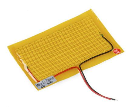
Cartuccia riscaldante flessibile, costituita da una rete di filamenti di poliestere e fibre di micro metallo conduttivo protetti da un Film di Polymide. Basta applicare una tensione di 5 Vdc e in pochi istanti inizia a riscaldarsi. Ideale per essere avvolta sul cilindro porta-siringa della 3DCHOCO, consente un riscaldamento uniforme della siringa. Può anche essere utilizzata per realizzare indumenti riscaldati e altro. Dimensioni (mm): 100x50. Assorbimento: Circa 750 mA (5Vdc).
