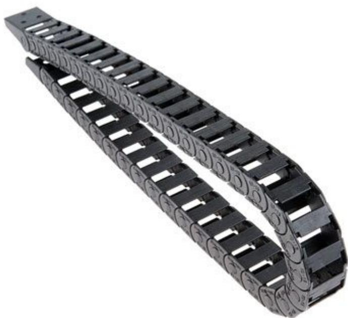
Catena portacavi particolarmente indicata per proteggere e guidare i cavi durante il movimento in macchinari come stampanti 3D, CNC o altri. Dimensioni (mm): altezza interna 10, larghezza interna 15, altezza esterna 14 e larghezza esterna 20.
