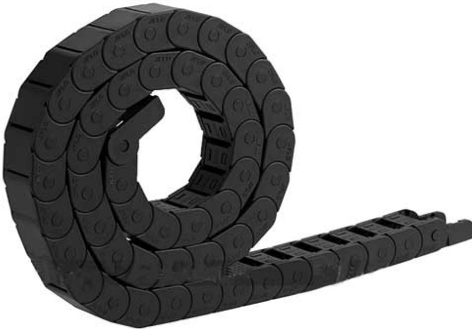
Catena portacavi particolarmente indicata per proteggere e guidare i cavi durante il movimento in macchinari come stampanti 3D, CNC o altri. Dimensioni (mm): altezza interna 10, larghezza interna 20, altezza esterna 15 e larghezza esterna 28.
