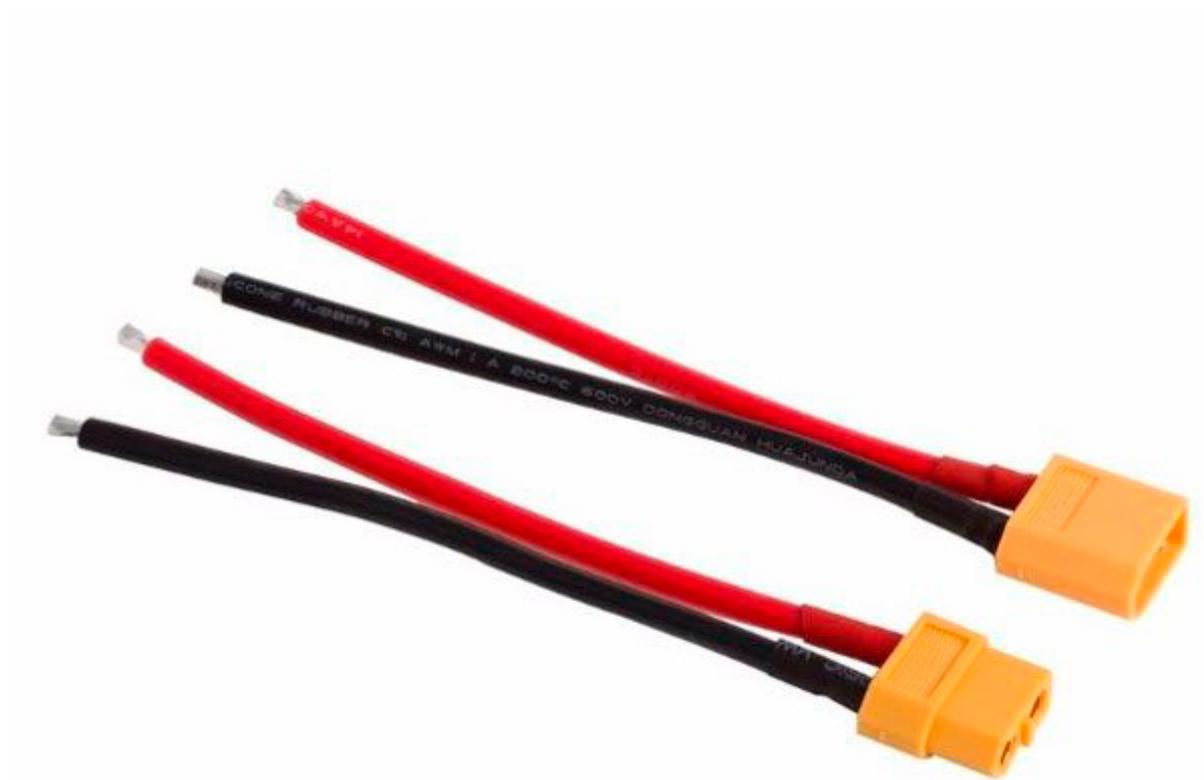
Confezione contenente due cavetti lunghi 10 cm, uno con connettore XT60 femmina e l'altro con connettore XT60 maschio. Dal lato opposto al connettore la parte terminale dei fili è spellata e stagnata. Il tipo di cavo è 14-AWG rivestito in silicone in grado di resistere fino a 200°C.
