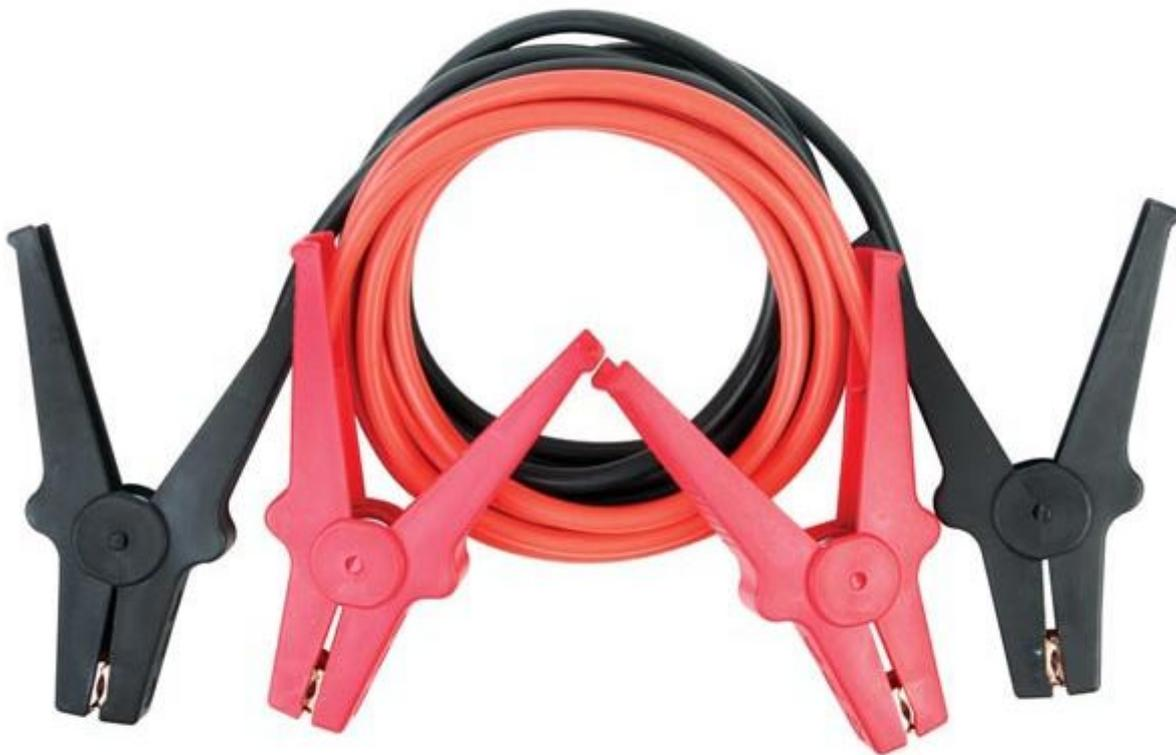
Coppia di cavi d'emergenza da 3 metri, con pinze completamente isolate, adatti per veicoli con cilindrata fino a 2500cc e batteria a 12 o 24V. Corrente massima 220 A; sezione 16mm<sup>2</sup>; certificati TÜV/GS e rispondono alla normativa di garanzia del prodotto DIN 72553. Completi di custodia.
