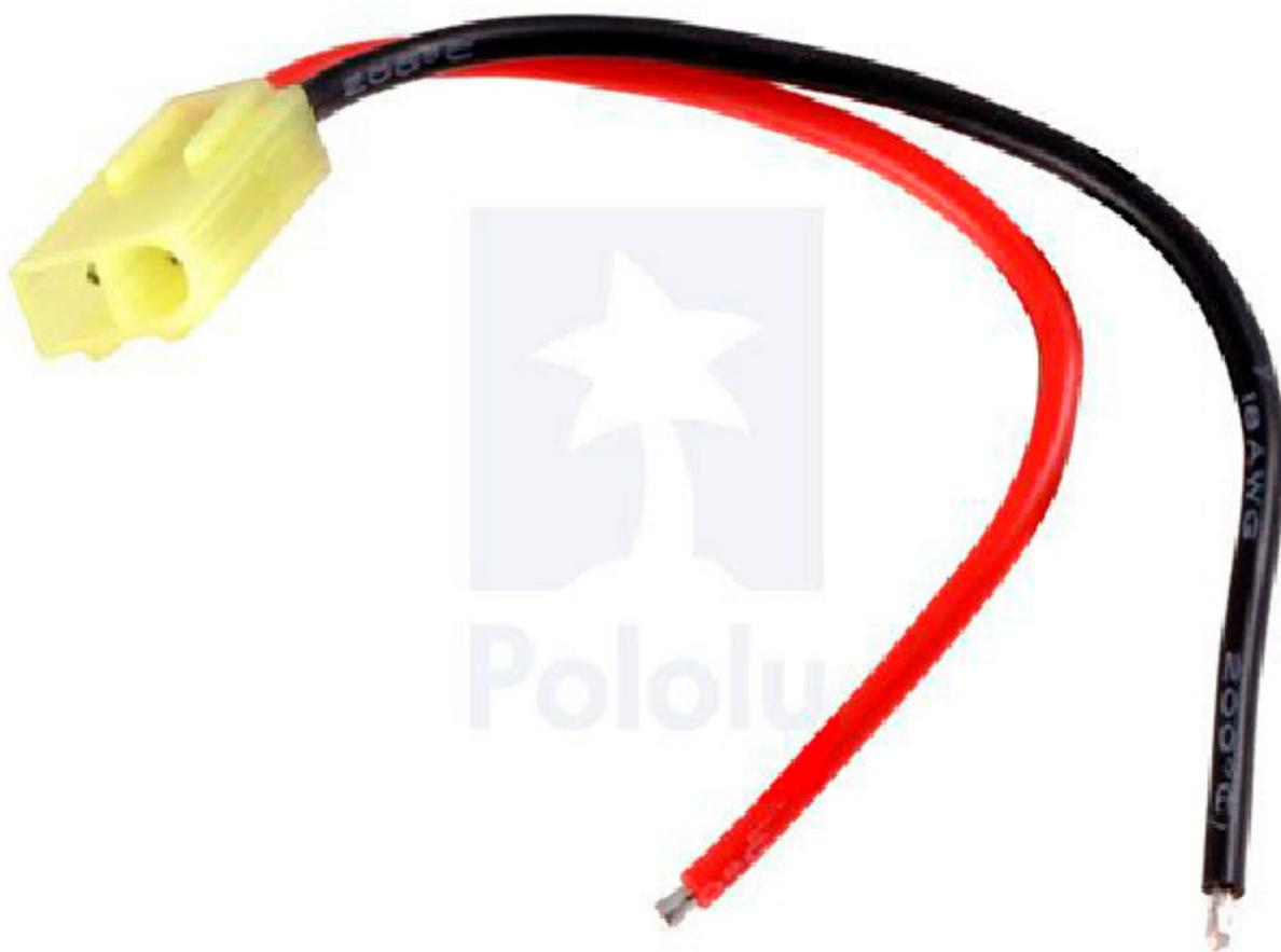
Comunemente utilizzato con pacchi batterie sub-C da 7,2 V, questo cavetto AWG da 10 cm è dotato di connettore maschio (a volte chiamato Tamiya o Kyosho) realizzato in modo da evitare l'inversione di polarità, con un fermo che evita lo sgancio dal connettore maschio e in grado di sopportare elevate correnti DC. **N.B.** questi connettori Tamiya a volte sono indicati nel settore hobby RC come "femmina", quindi assicuratevi con attenzione quello che volete.
