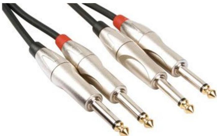
Cavo audio professionale dotato di 2 jack mono 6,35 mm da un lato e 2 jack mono 6,35 mm dall'altro. Lunghezza: 5 metri, conduttore interno: 0,12 mm x 20, calza: 0,12 mm x 30, diametro esterno: 6 mm.
