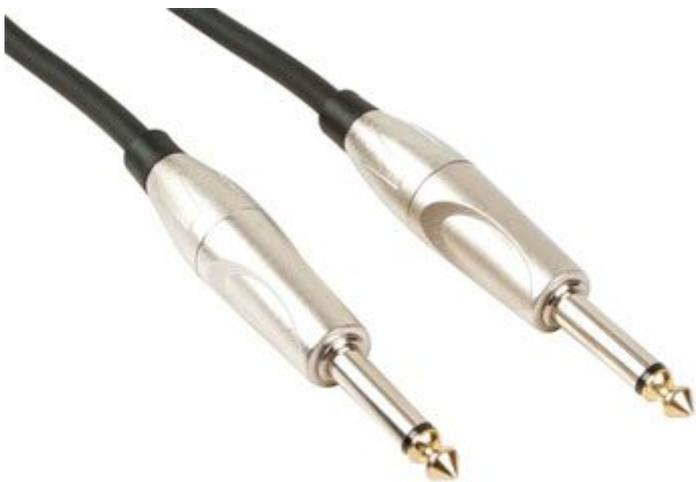
Cavo audio professionale dotato di 2 jack mono 6,35 mm. Lunghezza: 1 metro, conduttore interno: 0,12 mm x 20, calza: 0,12 mm x 30, diametro esterno: 6 mm.
