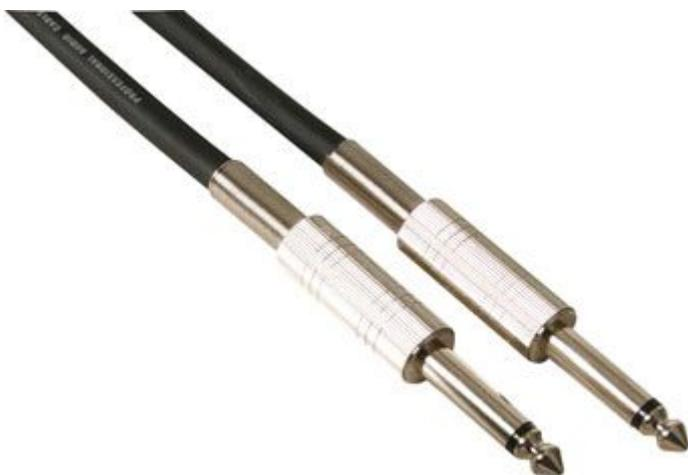
Cavo audio professionale dotato di jack mono 6,35 mm da un lato e jack mono 6,35 mm dall'altro. Lunghezza: 10 metri, sezione: 2 x 1,5 mm<sup>2</sup>, diametro esterno: 7 mm.
