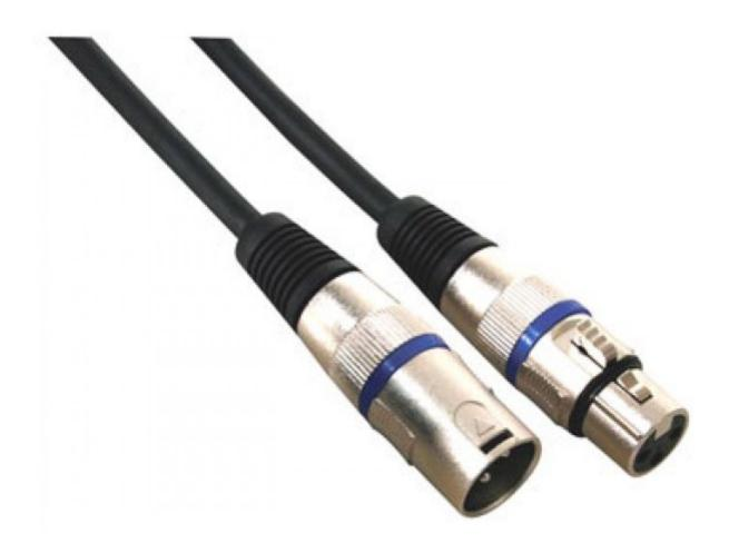
Cavo audio professionale dotato di connettore XLR 3 poli maschio e XLR 3 poli femmina. Colore: nero, lunghezza: 10 metri, conduttore interno: (0,12 mm x 20) x 2, calza: 0,12 mm x 64, diametro esterno: 6,5 mm.
